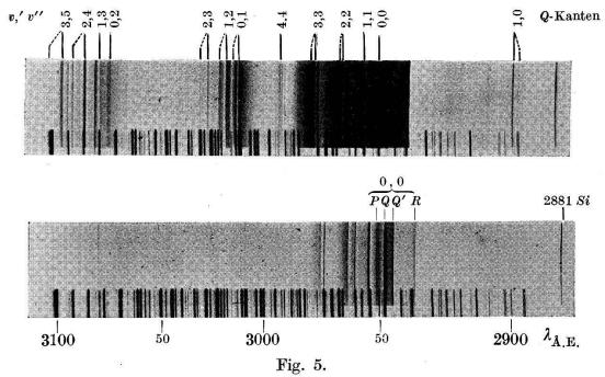
BBr. 2 Aufnahmen am 3-Quarzprismenspektrographen. In der unteren Aufnahme ist besonders deutlich die (0,0)-Bande sichtbar. In der oberen Aufnahme sind einige Q-Kanten, teils mit der Borisotopenaufspaltung angeschrieben.
