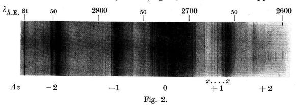
BCl. Aufnahme am 3m-Gitter, 2. Ordn. Die Bandengruppen sind mit den Werten von  $\Delta v = v' - v''$  bezeichnet.
