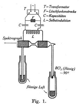
Geisslerrohr mit Aussenelektroden.
