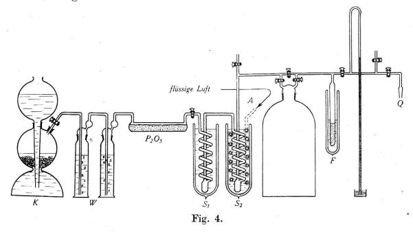
Die benutzte Apparatur ist in Fig. 4 schematisch skizziert. Wegen der grossen Reaktionsgeschwindigkeit zwischen NO und O<sub>2</sub> ist der Ausschluss von Luft wesentlich, was einerseits durch mehrmaliges Evakuieren der Apparatur und dazwischen liegendes Entwickeln, anderseits durch Auskochen der Lösungen und
