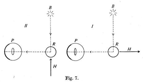
In der Figur sind für die beiden untersuchten Fälle I (rechts) und II (links) diejenigen Richtungen des Magnetfeldes angegeben, für die das Maximum in der Magnetfeldkurve auftritt.
