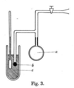
mischung c getaucht (feste Kohlensäure in Alkohol). Die Temperatur derselben konnte mit einem Pentanthermometer dauernd kontrolliert werden. Um sicher zu sein, dass in a der zur Temperatur in c gehörende Sättigungsdruck herrscht, wurde jeweils so lange gewartet, bis der Galvanometerausschlag unverändert blieb.
