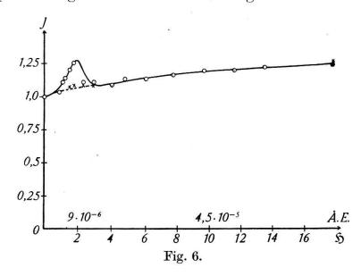
Erfahrungen, die man bis jetzt bei derartigen Effekten beobachtet hat, sollte die Intensitätsänderung im Magnetfeld von der Feldrichtung unabhängig sein. Dies war jedoch gar nicht der Fall, es zeigte sich vielmehr für die antiparallele Magnetfeldrichtung ein ganz deutliches Maximum bei 2 Gauss Feldstärke.
