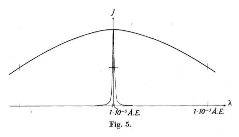
Damit scheint sichergestellt, dass für den Fall der Linie 2536,7 Å.E. es tatsächlich möglich ist, mit Hilfe des Atomstrahles eine Emissionslinie zu realisieren, bei welcher der Einfluss des Dopplereffekts praktisch vollständig eliminiert ist. Eine endgültige Entscheidung liesse sich nur treffen, wenn es möglich wäre, die genaue Intensitätsverteilung in der Linie zu bestimmen.
