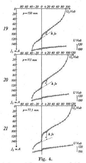
Sondencharakteristiken und Gesamtspannungen bei konstantem d und J (d=0.3 mm, J=0.45 Amp.) und variablem Druck p.
