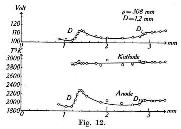
Behinderte Bogenentladung;  $J=0,\!45~\mathrm{Amp.}$  Spannungsbogenlängekurve mit dazugehörigen Temperaturkurven.
