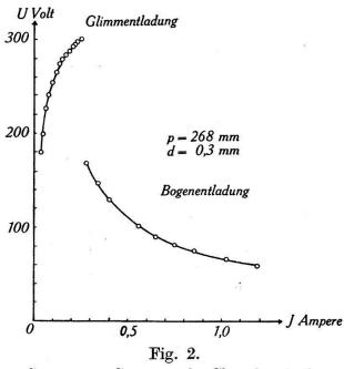
Spannungs-Stromstärke-Charakteristik. p = Druck, d = Bogenlänge.
