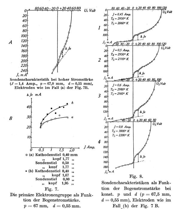
Bei der Stromstärke J=1,8 Ampère schmelzen beide Sonden. Daher wird in einem dritten Versuch eine vorn eben geschliffene Stabsonde vom Durchmesser 2 mm eingesetzt. Die Messungen sind durchaus negativ verlaufen. Infolge der tiefen Sondentemperatur wird nicht nur die mittlere freie Weglänge der primären
