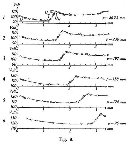
Behinderte Bogenentladung; J=0.45 Ampère. Spannungs-Bogenlängekurven.
