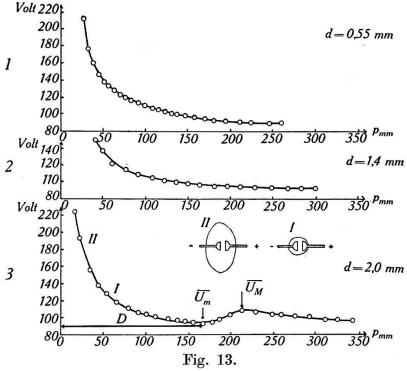
Bogenentladung; J=0.45 Ampère. Spannungs-Druckkurven.
