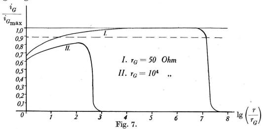
Verstärkerempfindlichkeit in Funktion des Anodenwiderstandes für  $r_G=10^4$  Ohm und  $r_G=50$  Ohm.
