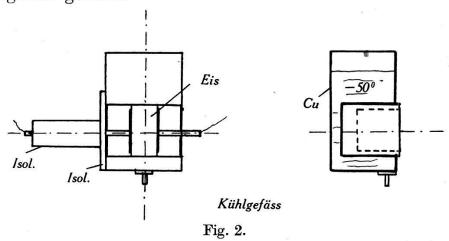
Die zwei Kupferelektroden werden durch Spiralfedern seitlich auf den Kristall gepresst. Der Hohlraum wurde von drei Seiten mit Glimmerisolation versehen. Zuerst wurde das Gefäss mit fester Kohlensäure gekühlt, dann ein rechteckiges Eisprisma  $(18 \times 15 \times 8 \text{ mm})$  eingesetzt und durch die Elektroden fest-
