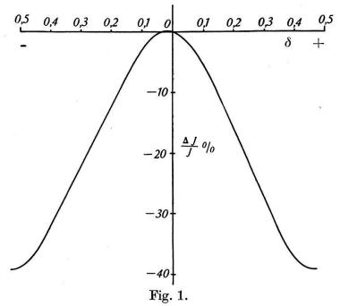
Relative Intensitätsänderung der Reflexion 100 bei Eis in Funktion der Atomverschiebungen.
