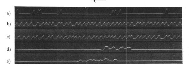
Fig. 2. Aufnahmen mit dem hydrostatischen Zähler in Verbindung mit Blattelektroskop. Registrierdauer ea.  $20^{\prime\prime}$ .
