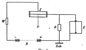
Fig. 8. Zählrohrschaltung.
