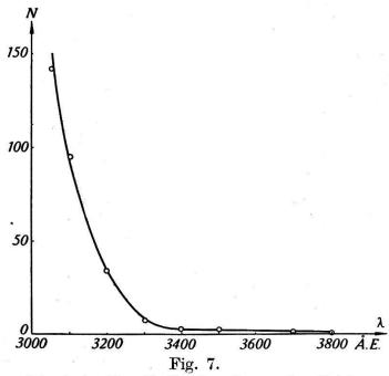
Photoelektrische Empfindlichkeitskurve des Zählrohrs  $Z_2$ .
