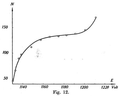
Abhängigkeit der Stosszahl N von der Spannung E beim Zählrohr  $Z_1$ .
