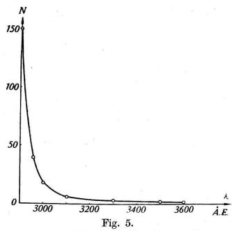
Photoelektrische Empfindlichkeitskurve des Zählrohrs Z<sub>1</sub>.
