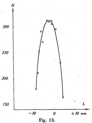
Stosszahl N bei horizontaler Verschiebung des Zählrohrs  $Z_1$  bei  $\lambda=2654$  Å.E.
