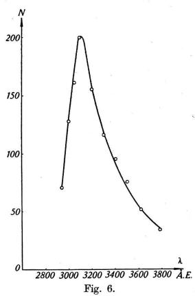
Ultraviolette Sonnenstrahlung, aufgenommen mit dem Zählrohr  $\mathbf{Z_1}$  in Arosa.
