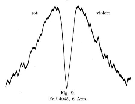
An der Kurve der druckverbreiterten Linie ist eine schwache Asymmetrie zu erkennen. Der langwellige Ast ist etwas stärker als der kurzwellige.
