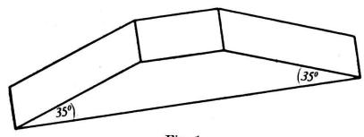
Fig. 1. Umkehrprisma aus Quarz.
