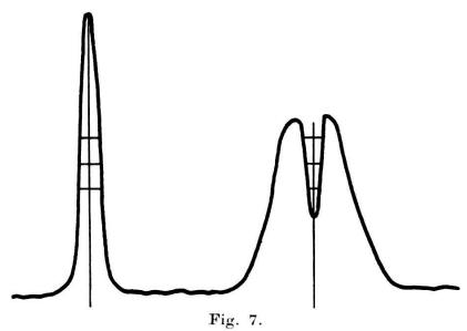
Die Bestimmung der Intensitätsmaxima an den Photometerkurven.
