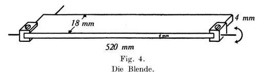
durch Horizontalstellen der Blende beide Filmhälften zu gleicher Zeit beleuchtet werden können.
