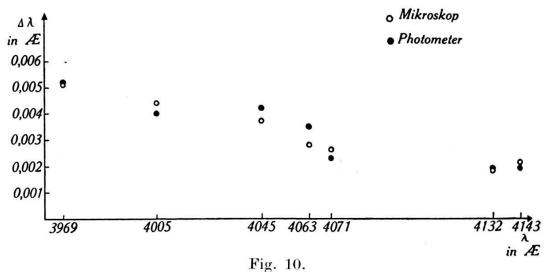
Die Abnahme der Grösse der Verschiebung mit zunehmender Wellenlänge.
