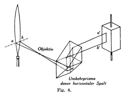
Schema der Flammenoszillogramm-Apparatur.
