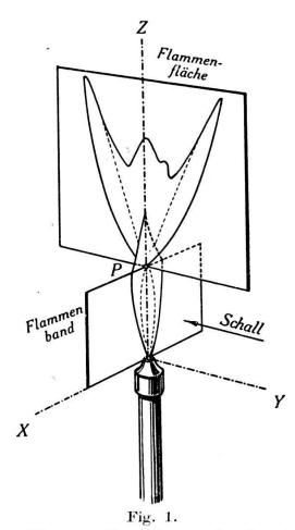
Flammenschema. Flammendüse, Flammenband und Flammenfläche.
