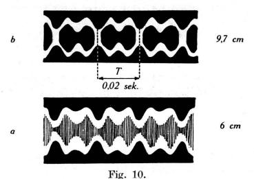
Oszillogramme der Flammenbreitseite. 50 Hertz. Gleichrichtereffekt.
