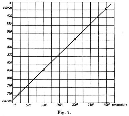
Dilatation thermique de l'Argent entre 20° et 300° C mesurée aux Rayons X.
