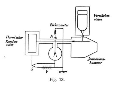
auch  $Q=C'\cdot v$ , wenn C' die Gesamtkapazität des Innensystems und v seine Spannung gegenüber der Aussenbelegung (Erde) bedeuten. v kann am Elektrometer abgelesen werden. Es wird
