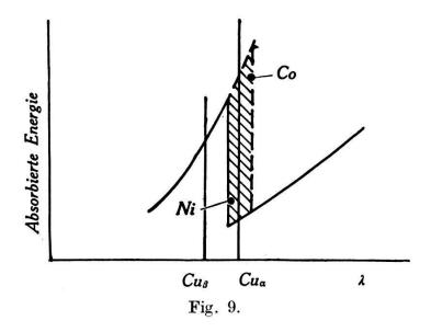
sorbieren, so entspricht der Differenz der vom Nickel und der vom Kobalt durchgelassenen Strahlung nur noch die  $\text{Cu-K}_{\alpha}$ -Linie. Dass eine solche Abgleichung der Filter erreicht werden kann, zeigt folgende kleine Überlegung.
