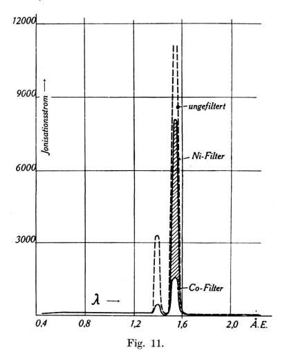
getragen werden können. Die schraffierte Fläche zeigt die Differenz der von den beiden Filtern durchgelassenen Strahlung, also die Strahlung, welche später in den Messungen verwendet wird. Sie hat eine Halbwertsbreite von 0,06 Å.
