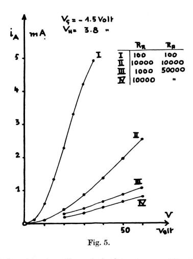
die Kennlinien für den Raumladegitterstrom. Für die Steilheit ist in erster Linie  $R_A$  bestimmend.
