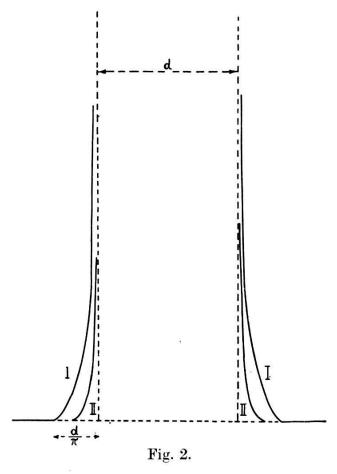
wenn man gleichzeitig dafür sorgt, dass die infolge der Krümmung einsetzende Tendenz zur Spannungserhöhung am Rande durch entsprechende Querschnittsverbreiterung kompensiert wird. Auf diese Weise gelangt man zu Profilen mit konstanter Randspannung.
