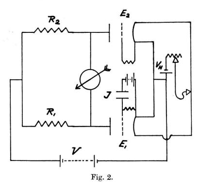
Brückenanordnung. Da die Röhren gemeinsame Batterien besitzen, ändern sich bei Spannungsschwankungen der Batterien die Anodenströme um den gleichen Betrag, so dass das Galvanometer keinen Ausschlag ergibt. Der zu verstärkende Photooder Ionenstrom wird nur einer Röhre zugeführt und stört das Gleichgewicht der Brücke.
