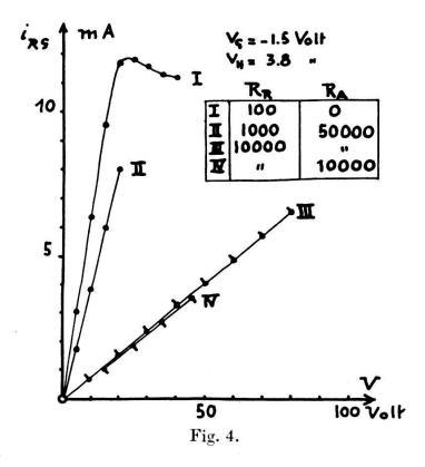
diente für diese Untersuchungen eine Doppelgitterröhre von Philips, A 441 N, da es bei diesen Versuchen nicht auf besonders gute Gitterisolation ankommt. Aus der Figur ist zu ersehen, und es ist leicht einzusehen, dass dies so sein muss, dass die Steilheit der Kennlinien fast nicht von der Grösse des Widerstandes im Anodenkreis abhängt, dagegen sehr stark vom Widerstand im Raumladegitterkreis.
