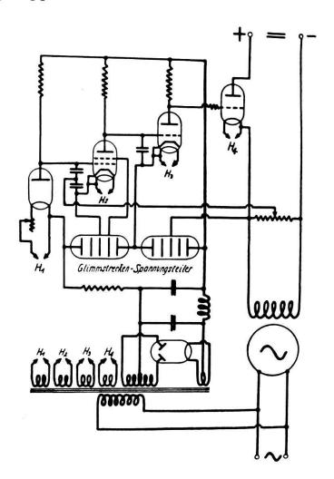
Rückkopplung mit Hilfe einer Gegenkopplung, die nur bei Schwingungen wirksam ist, ausgeglichen. Es dient dazu ein der Feldwicklung parallel geschaltetes Potentiometer, dessen Gleitkontakt über einen Kondensator mit dem Gitter der ersten Verstärkerröhre verbunden ist. Durch Gitter-Kathodekondensatoren wird verhindert, dass der Verstärker hochfrequent schwingt.
