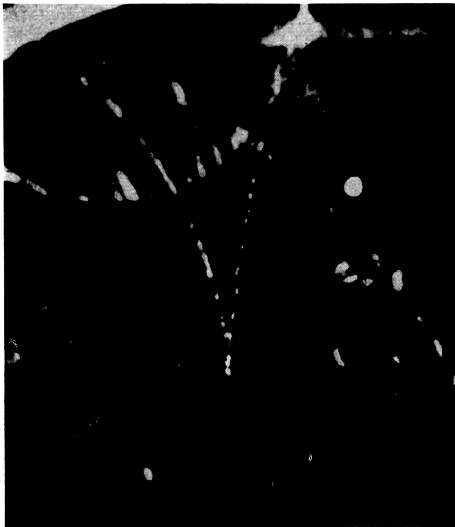
Photographie 1. Electron + et - issues du gaz de l'appareil Wilson.
