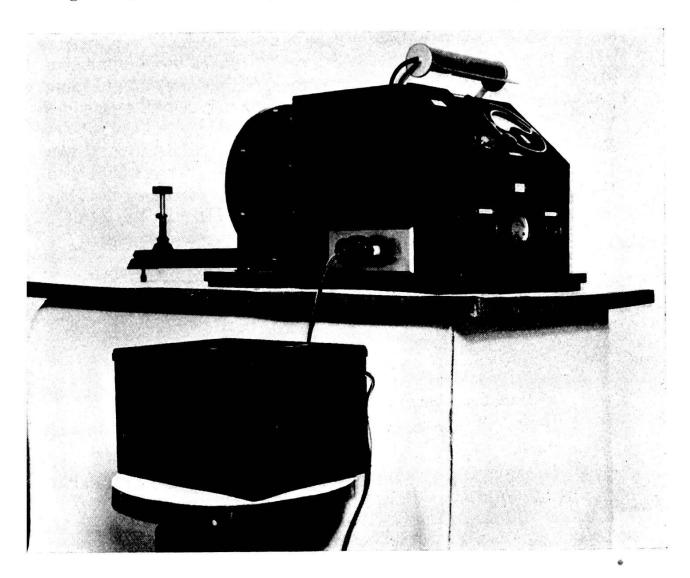
stände trägt. Die Präparate werden auf einen Träger gelegt, welcher auf einer Dreikantschiene in einem bestimmten Abstand von der Ionisationskammer befestigt werden kann. Die Empfindlichkeit des Instrumentes lässt sich durch Änderung dieser Distanz in weiten Grenzen regulieren. Das Netzanschlussgerät befindet sich in einem besonderen Kasten. Das Instrument wird durch einen einzigen Schalter betriebsfertig eingeschaltet.
