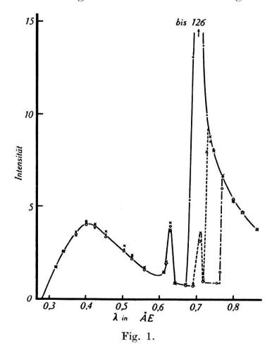
an den Gasen: Argon, Sauerstoff und Stickstoff, sowie an einer Anzahl fester Elemente und Verbindungen gemacht worden. Die Gase wurden unter hohem Druck (etwa 20 Atm.) in einer besonders konstruierten Kammer, mit Celluloidfenstern für eintretenden und austretenden Strahl, gehalten. Die streuenden Substanzen wurden in den Primärstrahl in die Mitte des Spektrometertisches gestellt, und die Ionisationskammer unter einem Winkel von 120°
