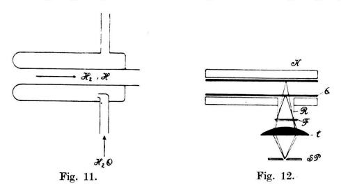
Es wurde ein Strömrohr folgender Art entworfen, mit dem es möglich war, Untersuchungen bis zur Dauer von mehreren Minuten auszudehnen. Fig. 11 zeigt dieses aus Pyrexglas im Sauerstoffgebläse hergestellte Rohr<sup>2</sup>).
