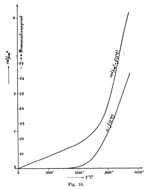
gramm jeden, dem thermischen Gleichgewicht entsprechenden Dissoziationsgrad ablesen. Die Wärmemengen, mit denen gemessen wurde, bewegten sich zwischen 0,4 bis 0,7 cal/cm³. Für diese Wärmemengen konnte man, nachdem das Gas eine 8 cm lange Strombahn durchlaufen hatte, deren Durchmesser zirka 1,8 cm betrug, bei einer strömenden Gasmenge von 150 ccm/sec (in kaltem Zustande gemessen) Dissoziationsgrade von X=0.041 bis X=0.0715 nachweisen. Das Gas braucht zur Zurücklegung
