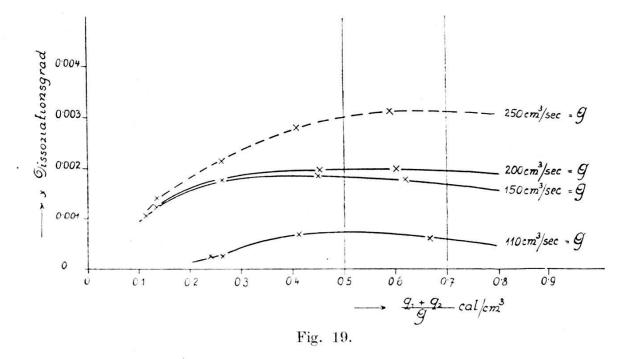
Aus den Tabellen sind die Diagramme Figur 14—19 gezeichnet worden. Die Figuren 14, 15, 16 stellen für die Enden der 3 Strömrohre die Temperaturen des Gases in Funktion der Wärmemengen  $q_1+q_2/G$  dar. Die Figuren 17, 18, 19 die Konzen-
