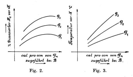
In Figur 2 wird der Prozentgehalt von dissoziiertem Wasserstoff vor dem Katalysator in Funktion der pro Kubikzentimeter der strömenden Wasserstoffmenge G bei B zugeführten Energie (cal) dargestellt. Als Parameter wurde die Gasmenge  $G_n$  variiert. In ähnlicher Weise wird in Figur 3 die Temperatur  $t_a$  °C vor dem Katalysator dargestellt. Aus diesen Kurvenscharen kann die
