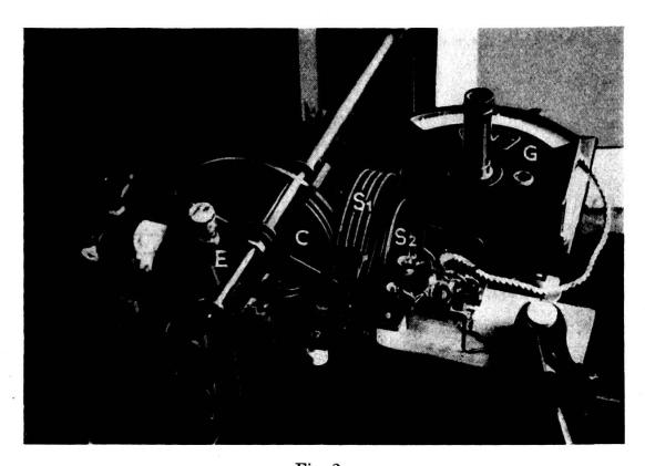
Fig. 2. Circuit de mesure à résonance. ( $\lambda=18$  m.). C= Condensateur de mesure. E= Eprouvette.  $S_1=$  Self d'accord.  $S_2=$  Self induite. D= Détecteur à cristal. G= Galvanomètre.
