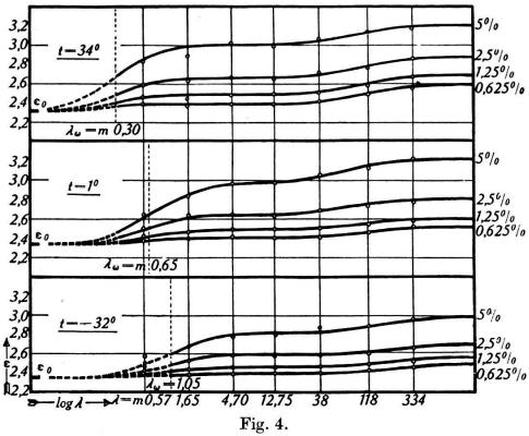
Dispersion du nitrobenzène dissous dans l'huile Shell BL3. Action de la température.
