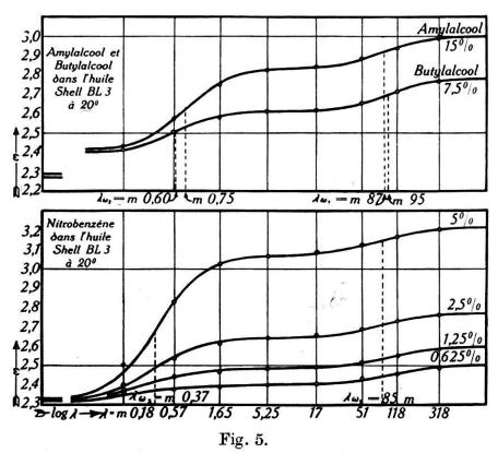
En haut: courbes de dispersion de l'amylalcool et du butylalcool dissous dans l'huile Shell BL3. — En bas: courbes du nitrobenzène dans le même solvant.
