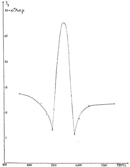
Fig. 5. "Resonanzkurve" in der Multivibratorschaltung bei Selbsterregung (Mitnahme-Effekt).
