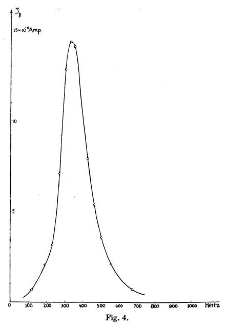
"Resonanzkurve" in der Transformatorschaltung bei fehlender Selbsterregung.
