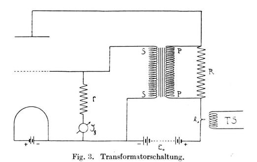
essen Ausschläge ( $J_g$ ) als ein relatives Mass für die vorhandenen chwingungsamplituden dienten. Der Multivibrator wurde durch Vahl der Widerstände so einreguliert, dass er sich gerade unteralb der Grenze der Selbsterregung befand, also stark verminerte Dämpfung besass; der Gitterstrom war dann noch gering. Vurde nun der Tonsummer in Betrieb gesetzt und seine Frequenz ontinuierlich variiert, so ergaben sich als Resultat die Resonanzurven<sup>2</sup>) Fig. 2.
