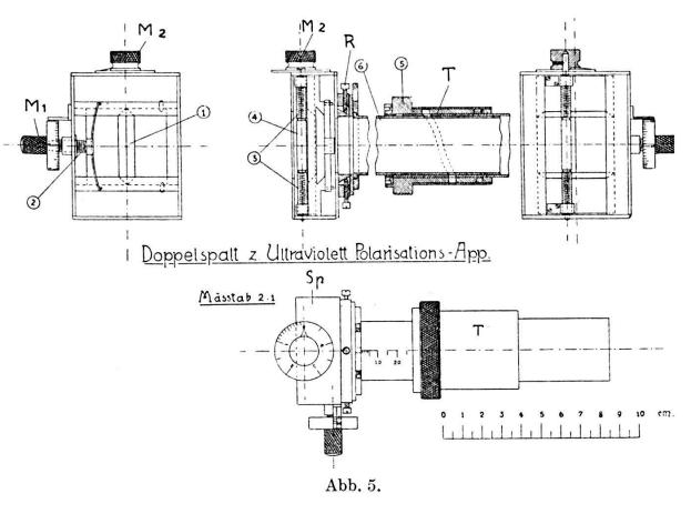
festigt. Es ist ein Quarz-Flusspatachromat von 50 cm Brennweite und 4,0 cm Durchmesser. Prismen und Achromat sind von der Firma Zeiss geliefert.
