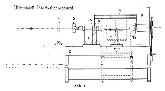
nisch verbunden ist, ausser durch die Grundplatte. Er ist durch eine Schraube drehbar und kann in jede beliebige Position gebracht werden, die mit einem Teilkreis bis auf ½0 Grad ablesbar ist. Die Grundplatte, welche Kollimator und Polarisator trägt, sitzt auf den Leitschienen auf und kann an geeigneter Stelle festgeklemmt werden.
