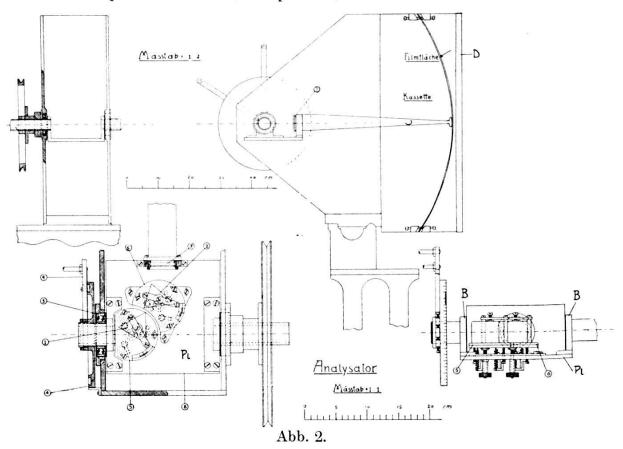
auf der geschwärzten Wand der Kamera absorbiert wird. Das Spektrum wird mit einem Flusspat-Quarzachromaten in 50 cm Entfernung auf einem Film entworfen. Das Minimum der Ablenkung für beide Prismen ist etwa für die Wellenlänge 3000 A.E. eingestellt. Diese Wellenlänge liegt in der Mitte des Spektrums von 14 cm Länge und hat eine Ablenkung von 90°. Das abgebildete Spektrum reicht von 5800 bis 2500 und ist überall von guter Schärfe.
