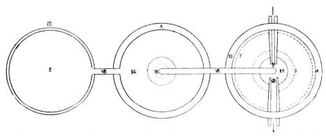
Fig. 2. Grundriss, R Reservoir, RD Reservoirdeckel, VR Verbindungsrohr, SG Siedegefäss, A Asbestumhüllung, HS Heizspiralen, K Kamerawand, B Blende, GB Gegenblende, Pfeile: Richtung des Röntgenstrahls, KM Kühlmantel, S Schattenapparat, F Film, KS Kühlschlange.
