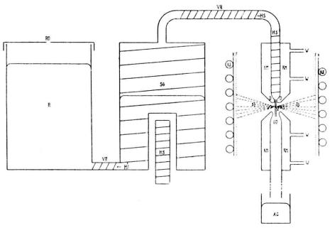
Fig. 1. R Reservoir, RD Reservoirdeckel, VR Verbindungsrohr, SG Siedegefäss-HS Heizspiralen", K Kamerawand, D Düse, GD Gegendüse, KM Kühlmantel, W Wasserleitungen, KS Kühlschlange, F Film, S Schattenapparat, X Röntgenstrahl (senkrecht zur Papierebene), AG Auffanggefäss für das kondensierte Quecksilber.
