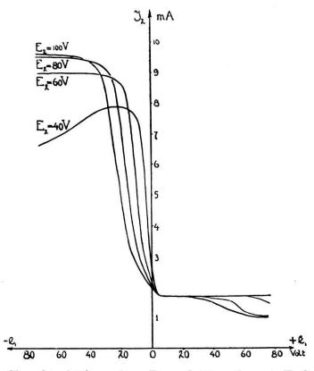
Fig. 3. Charakteristiken einer Doppelgitterröhre A. E. G., K 25.
