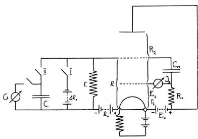
Fig. 4. "Tetroden-Multivibrator". I und II Kontakthebel des Helmholtz'schen Pendels. G ballistisches Galvanometer.
