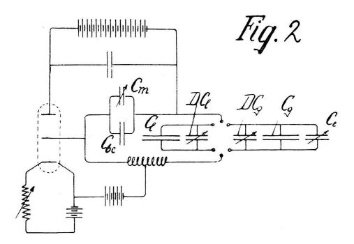
kapazitive Veränderung  $\Delta$   $C_g$  des Gaskondensators ausgedrückt durch die Kompensation  $\Delta$   $C_m$  des Messkondensators
