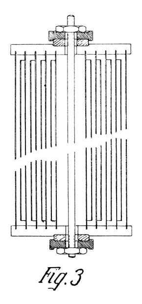
$DC_1$  und  $DC_g$  dienen dazu, allfällige kleine Differenzen konstruktiver Natur zwischen  $C_1$  und  $C_g$  auszugleichen. Damit gestaltet sich das Schema des endgültigen Aufbaues des Schwingungskreises II wie folgt:
