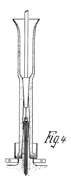
chemische Reaktionen zwischen Kondensator und Dampf auf ein Minimum zu beschränken, wurden die Zylinder samt Bügeln und Schraube beider Kondensatoren vergoldet. Die Vergoldung wurde ausgeführt durch die Firma J. Breguet-Breting, Uhrenschalenfabrik, Biel.
