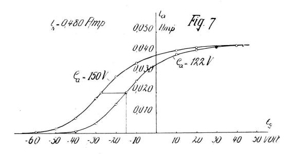
sehr vorteilhaft erwiesen, indem sie grosse Anforderungen in Bezug auf konstante Frequenz restlos erfüllten. Näheres ist aus der angeführten Röhrencharakteristik (Fig. 7) ersichtlich; beigefügt sei nur, dass ihre guten Eigenschaften hauptsächlich von der geringen Erwärmung herrühren. Die Röhren arbeiten bei schwacher Rotglut. Beide Röhren werden vollständig unabhängig voneinander betrieben, jede mit eigener Anoden-, Gitter- und Heizbatterie, bei 122 Volt Anoden- und —15 Volt Gittervorspannung.
