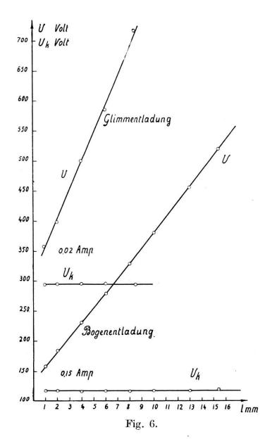
Kathodenfall dieser Form zu messen. Aus 7 Messungen bei den Bogenlängen 8—19,8 mm ergibt sich  $27 \pm 2$  Volt, während die stabile Form  $32,1 \pm 0,8$  Volt, d. h. 5 Volt mehr aufweist. Das dürfte der Grund sein, dass bei geringer Verunreinigung (Undichtigkeit des Kolbens) die unruhige Bogenform mit kleinem Kathodenfleck immer häufiger wird, bis schliesslich die stabile Form nicht mehr erhalten werden kann.
