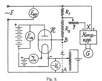
$V_0 = -0.50$  V. durch eine der Röhre vorgespannte Hilfsspannung  $-V_0 = +0.50$  V. in den Nullpunkt verschoben wird (strichpunktierte Kurve), einen konstanten Widerstand von  $r = 20\,000 \pm 100$   $\Omega$  dar (zwischen A und B, Fig. 2). Aus der ausnützbaren Länge der Kennlinie und der Grösse der zu untersuchenden Spannung (50 bis 150  $V_{\rm eff}$  ergeben sich die Vorschaltwiderstände  $R_1 + R_2$ .
