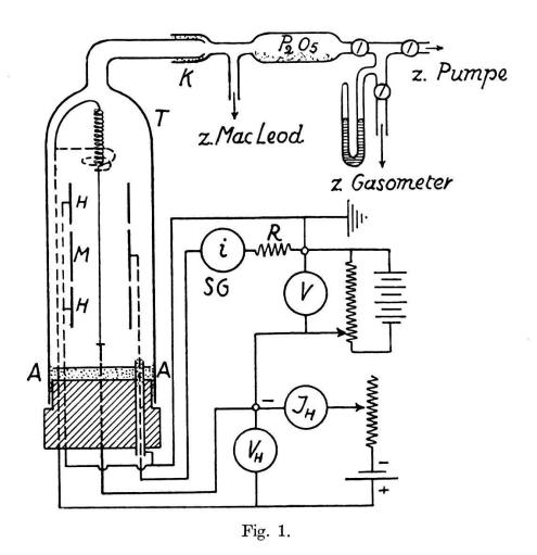
wie die Röhre drehbar über eine horizontale Kittstelle K vermittelst eines Dreiweghahns, der den Einlass bestimmter kleiner Gasmengen gestattet, einerseits an den Gasometer, andererseits
