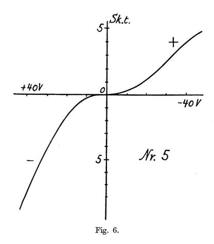
mit Ionen 1. Art eines frischen Pt-Drahtes aufgenommene Charakteristik. Die verschiedenen Beweglichkeiten der positiven und negativen Ionen sind an den verschieden stark gekrümmten Parabelstücken leicht zu erkennen.
