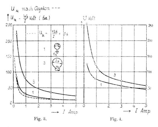
In Figur 3 und 4 sind die Werte von  $U_k - W_3/I$  bzw. U für den Fall 1 und 3 als Funktion der Stromstärke I aufgetragen.
