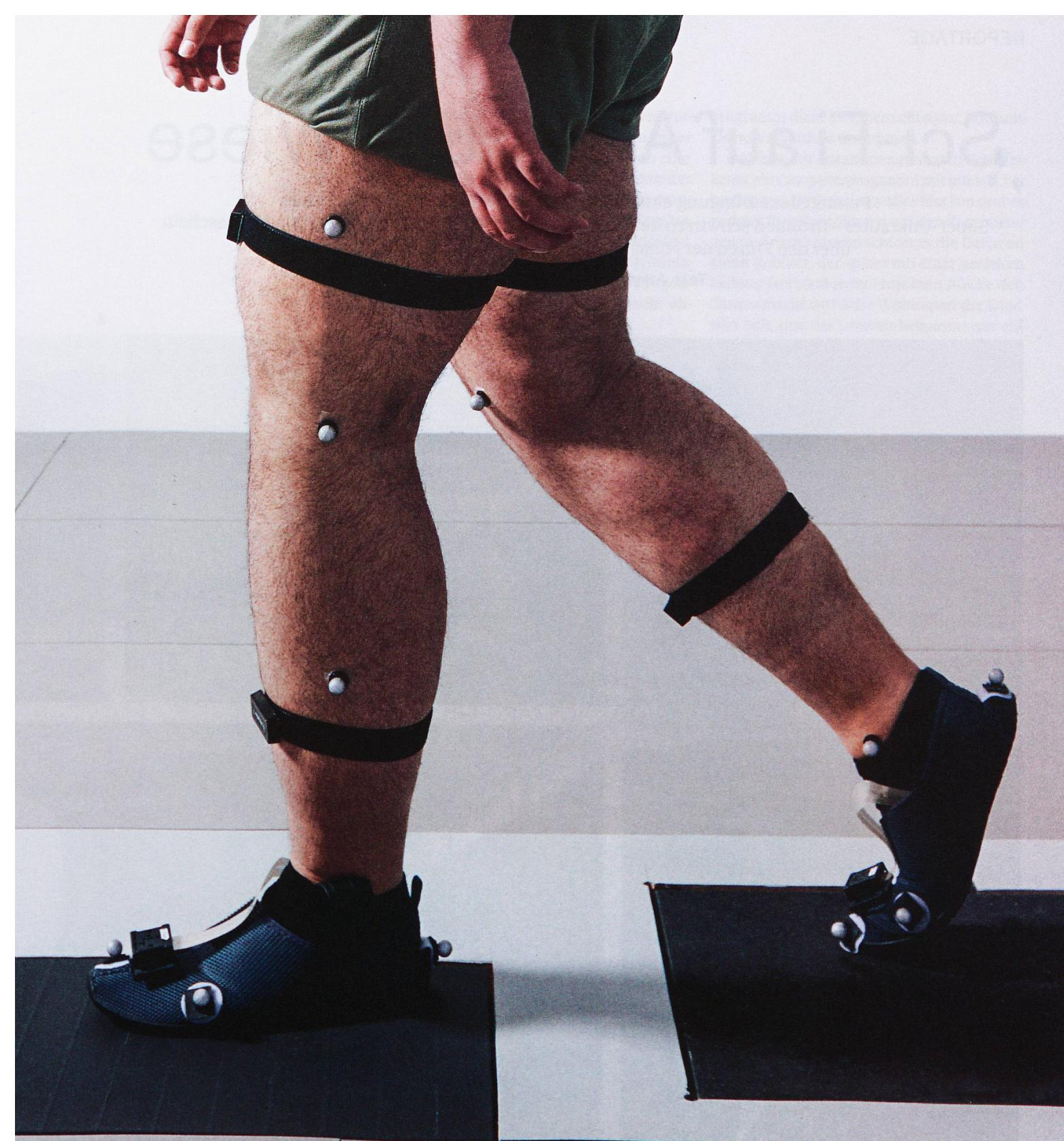
Die Sensoren an den Beinen erlauben es den Forschenden am Labor für Bewegungsanalyse und -messung der EPFL, die Belastung des Kniegelenks zu bestimmen.
