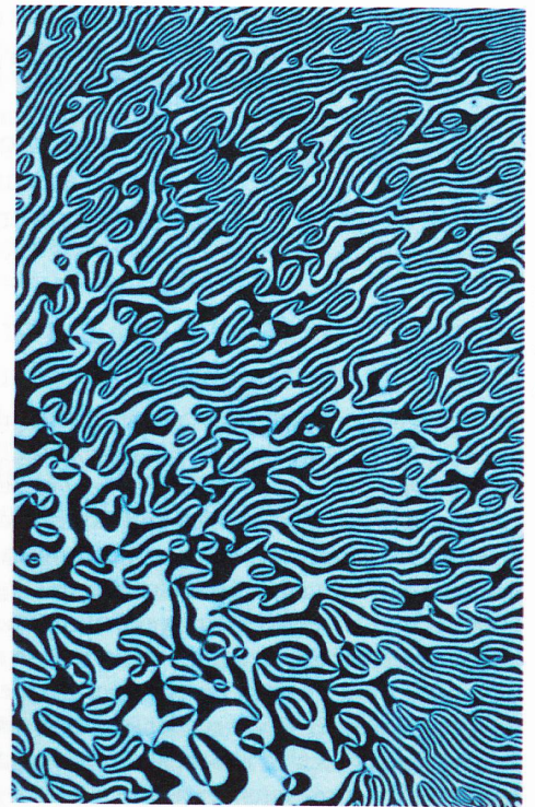
In Erbi-Mangan-Oxid können magnetische Felder mittels elektrischer Felder umgepolt werden. Das braucht viel weniger Energie, als für herkömmliche Computerbauteile aus Silizium benötigt wird.
