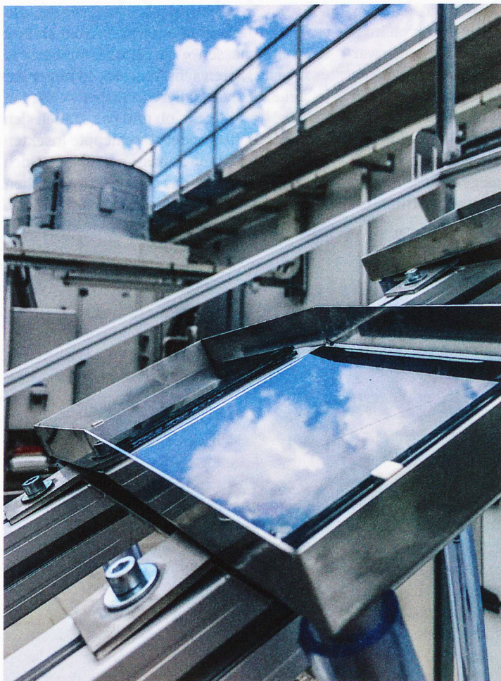
Auf dem Dach in Muttenz wird getestet, ob aus Solarzellen aus Perowskit Blei ins Regenwasser gelangen kann. Foto: zVg
