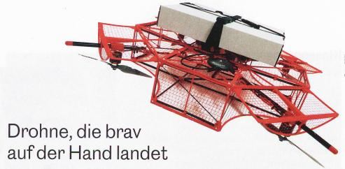
Lastendrohnen brauchen spezielle Landeplätze, denn die Rotoren stellen beim Starten und Landen eine Gefahr dar. Der Robotik-Forscher Przemyslaw Kornatowski hat nun eine Drohne entwickelt, die ihre Rotoren bei niedrigen Höhen in einen starren Käfig einzieht. Dies verschlechtert zwar die Aerodynamik, macht die Drohne aber so sicher, dass sie auf der Hand landen kann. So können etwa kranke Menschen ihre Medikamente auf dem Balkon in Empfang nehmen. yv
