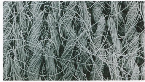
Polyesterfasern in einem Interlockstoff unter dem Elektronenmikroskop. Foto: Y. Cai et al. (2020)
