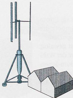
Anstatt wie üblich mit horizontaler Lagerung, entwickelt Agile Wind Power Windräder mit vertikaler Rotorachse. Sie haben gemäss der Firma mehrere Vorteile: Es entsteht deutlich weniger Lärm, und die Anlagen würden Vögel und Fledermäuse schonen. Gerade in der dezentralen Stromproduktion, etwa in der Nähe von Siedlungen, eröffnet sich für die Vertikalen darum eine Nische.
