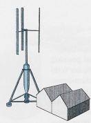
Anstatt wie üblich mit horizontaler Lagerung, entwickelt Agile Wind Power Windräder mit vertikaler Rotorachse. Sie haben gemäss der Firma mehrere Vorteile: Es entstehe deutlich weniger Lärm, und die Anlagen würden Vögel und Fledermäuse schonen. Gerade in der dezentralen Stromproduktion, etwa in der Nähe von Siedlungen, eröffnet sich für die Vertikalen darum eine Nische.
