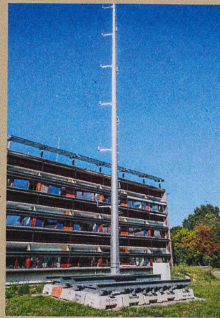
Windmessung auf unterschiedlichen Höhen: Der EPFL-Campus als Modell für Stadtschluchten.
