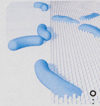
Die Nanosäulen einer antibakteriellen Oberfläche reissen Bakterienmembranen auf.
