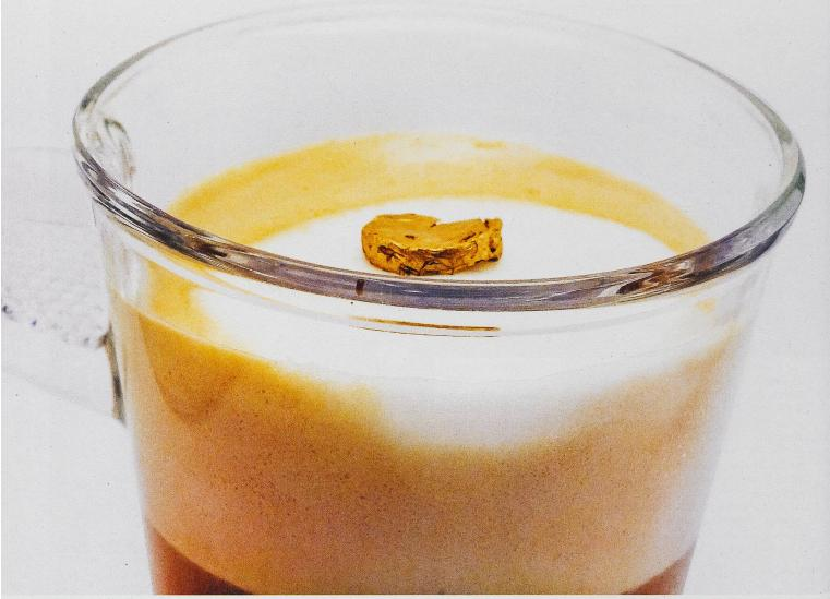
Eine Art Schwamm aus Gold und Protein: Das Aerogel mit wenig Feststoff und grosser Oberfläche könnte einmal ein Katalysator werden. Bild: Nyström/Mezzenga
