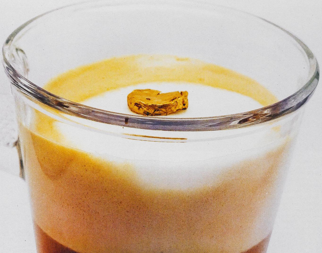
Eine Art Schwamm aus Gold und Protein: Das Aerogel mit wenig Feststoff und grosser Oberfläche könnte einmal ein Katalysator werden. Bild: Nyström/Mezzenga
