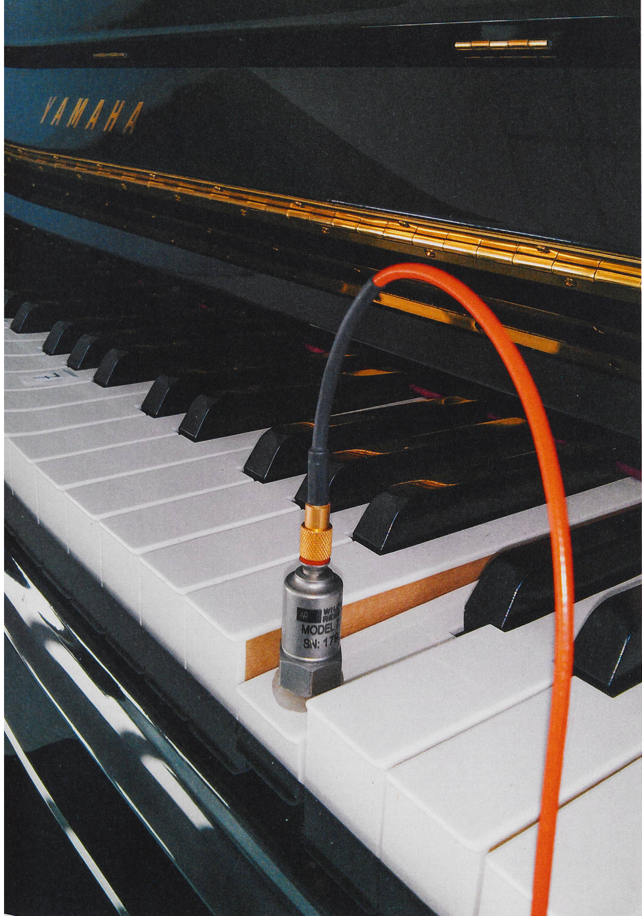
Der Beschleunigungsmesser zeichnet auf, wie stark die Taste vibriert. Das Wissen haben die Forschenden benutzt, um ein digitales Piano zum Schwingen zu bringen, als ob es ein richtiges Klavier wäre . Bild: Stefano Papetti
