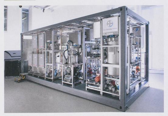
Eine standardisierte Minifabrik, transportierbar im Container: Dies ist die Vision des europäischen Forschungsprojekts F3-Factory. Bild: Invite GmbH
