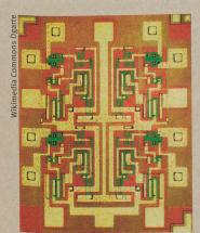
Egal wie klein, der Transistor - im Bild ist ein vierfaches Nand-Gatter - wird dennoch heiss.
