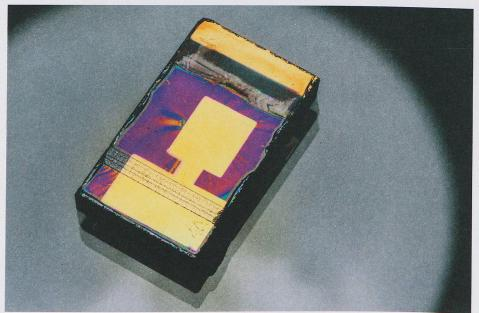
Entwickelt an der EPFL liefert diese neue Generation von Solarzellen auf der Basis von Perowskit eine Ausbeute von über 20 Prozent. Bild: Alain Herzog/EPFL
