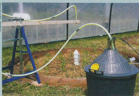
Die Schadstoffe sickern durch das Stück Boden, werden aufgefangen und analysiert.
