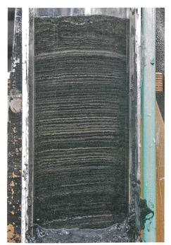
Bohrkern aus dem Seegrund des Greifensees. Jedes Jahr wird eine helle und eine dunkle Sedimentschicht abgelagert. Bild: Piet Spaak, Eawag
