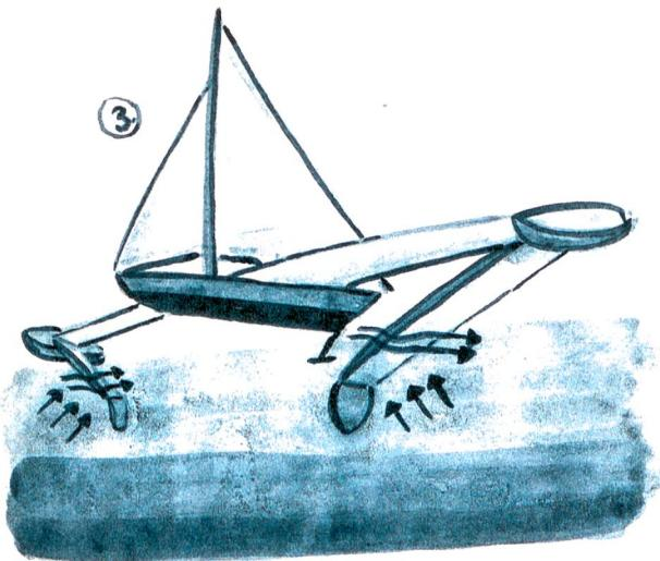
Am besten lässt sich dieser Widerstand verringern, wenn das Boot aus dem Wasser gehoben wird. Dies geschieht mit Tragflügeln, einer Art Unterwassertragflächen: Sie heben beim Erreichen einer bestimmten Geschwindigkeit den Rumpf aus dem Wasser. Dadurch kann das Boot weiter beschleunigen, bis ein neues Gleichgewicht zwischen Widerstand und Antrieb erreicht wird.
