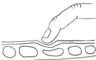
**2** Zwei dieser Technologien machen sich elektrische Phänomene zunutze. Bei der resistiven Methode kommen durch den Druck einer Berührung des Bildschirms zwei leitende Schichten zusammen, die durch eine Widerstandsschicht getrennt sind. Dieser Kontakt erzeugt Veränderungen im elektrischen Feld der Schichten. Daraus werden die Koordinaten errechnet. Bei jedem Kontakt erfolgt eine elektrische Entladung, durch die das System nach und nach abgenutzt wird.
