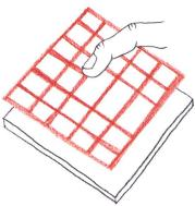
4 Bei Infrarotsystemen schliesslich ist der Bildschirm von Infrarotsendern und -empfängern umgeben. Die bei der Berührung des Bildschirms unterbrochenen Strahlen lassen auf die Kontaktstelle schliessen. Der Bildschirm hat hier eine passive Rolle; die Position des Fingers wird bestimmt, ohne dass der Bildschirm wirklich berührt wird, also eigentlich ohne Touch.
