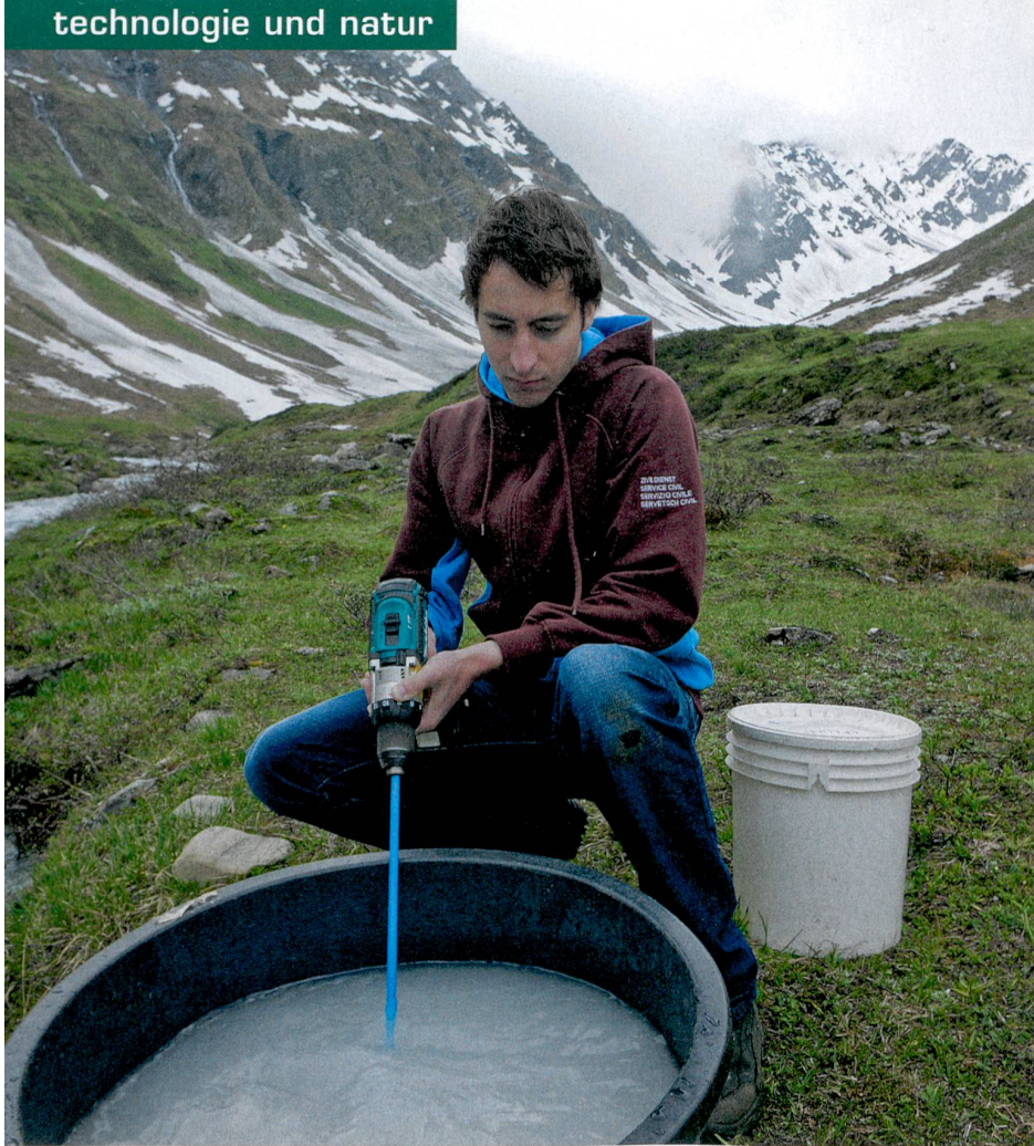
Experiment am Berg: Während der eine Forscher die Kochsalzlösung präpariert (links), bringt der andere die Sonde im Fluss an.
