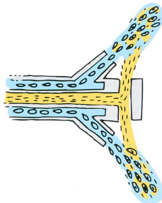
Die Tröpfchen gefrieren dank der Kälte der Umgebungsluft. Die Verfestigung findet somit von aussen nach innen statt, wodurch eine Kugelform entsteht, die sich von der Form natürlicher Schneeflocken unterscheidet. Damit die Kugelchen genügend Zeit haben, vollständig zu gefrieren, bevor sie auf dem Boden ankommen, werden die Düsen in rund zehn Metern Höhe angebracht, zum Beispiel an Stangen. Die Grösse der Schneekristalle hängt einzig von der Grösse der versprühten Tröpfchen ab.
