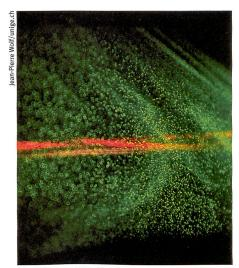
Experiment in der Nebelkammer: Der innovative Laserstrahl (rot) inmitten der grün illuminierten Wassertröpfchen.
