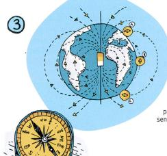
Der Kompass nutzt das Erdmagnetfeld, das sich in erster Näherung wie ein Magnet mit zwei Polen verhält. Die Feldlinien gehen vom magnetischen Nord- zum magnetischen Südpol. Sie verlaufen beim Äquator parallel und bei den Polen senkrecht zur Erdoberfläche.
