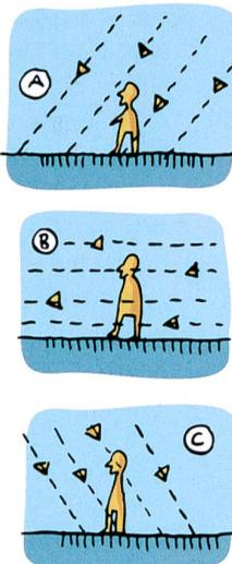
Die Magnetnadel richtet sich entlang dieser Feldlinien aus. Da diese nur gerade beim Äquator parallel zum Boden sind, ist ein Ende der Nadel mehr oder weniger stark gegen den Boden geneigt. Das andere Ende muss etwas beschwert werden, damit die Nadel das Ziffernblatt nicht berührt. Ein für die Nordhalbkugel gefertigter Kompass funktioniert deshalb auf der Südhalbkugel nicht, da der Ballast auf der verkehrten Seite ist.
