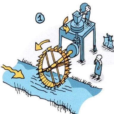
Nichts entsteht ganz neu, nichts geht verloren, alles wandelt sich. Von diesem Grundgesetz der Natur profitiert der Mensch, wenn er – seit der Antike – die Wasserkraft nutzt: Wasser fliesst unter und über ein Rad mit Schaufeln, das Rad ist über Achsen und Zahnräder mit einem Mühlstein verbunden, und dieser gerät in Bewegung.
