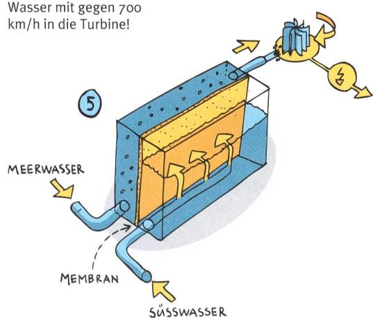
Derzeit wird eine neue Technologie zur Nutzung der Wasserkraft entwickelt, die auf dem Phänomen der Osmose beruht. Mit Süßwasser aus einem Fluss wird über eine semipermeable Membran in Meerwasser ein osmotischer Druck aufgebaut, mit dem eine Turbine angetrieben wird. Diese Technik ist noch nicht marktauglich und sehr komplex. Ihr Vorteil: Sie stellt nur einen schwachen Eingriff in die Umwelt dar.
