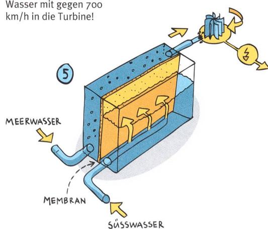
Derzeit wird eine neue Technologie zur Nutzung der Wasserkraft entwickelt, die auf dem Phänomen der Osmose beruht. Mit Süßwasser aus einem Fluss wird über eine semipermeable Membran in Meerwasser ein osmotischer Druck aufgebaut, mit dem eine Turbine angetrieben wird. Diese Technik ist noch nicht markttauglich und sehr komplex. Ihr Vorteil: Sie stellt nur einen schwachen Eingriff in die Umwelt dar.
