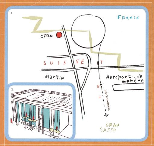
**Abb. 1** Im SPS-Teilchenbeschleuniger des Cern werden Protonen mit sehr hoher Energie auf ein Graphittarget (T) geschossen. Dabei entstehen positiv geladene Teilchen: Pionen und Kaonen; sie werden durch ein magnetisches Linsensystem zu einem parallelen Strahl fokussiert und zerfallen in einer 1000 Meter langen, evakuierten Röhre teilweise zu Myon-Neutrinos und Myonen.
