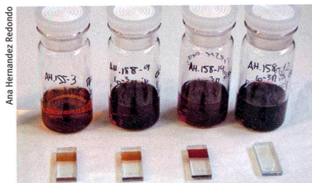
Vielversprechend: mit Kupferfarbstoffen beschichtete Solarzellen (vier Muster)
