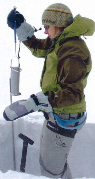
Die Forscherin Ruzica Dadic misst die Schneedichte. Unten: Ansichten vom Arolla-Gletscher zwischen Juni und September.
